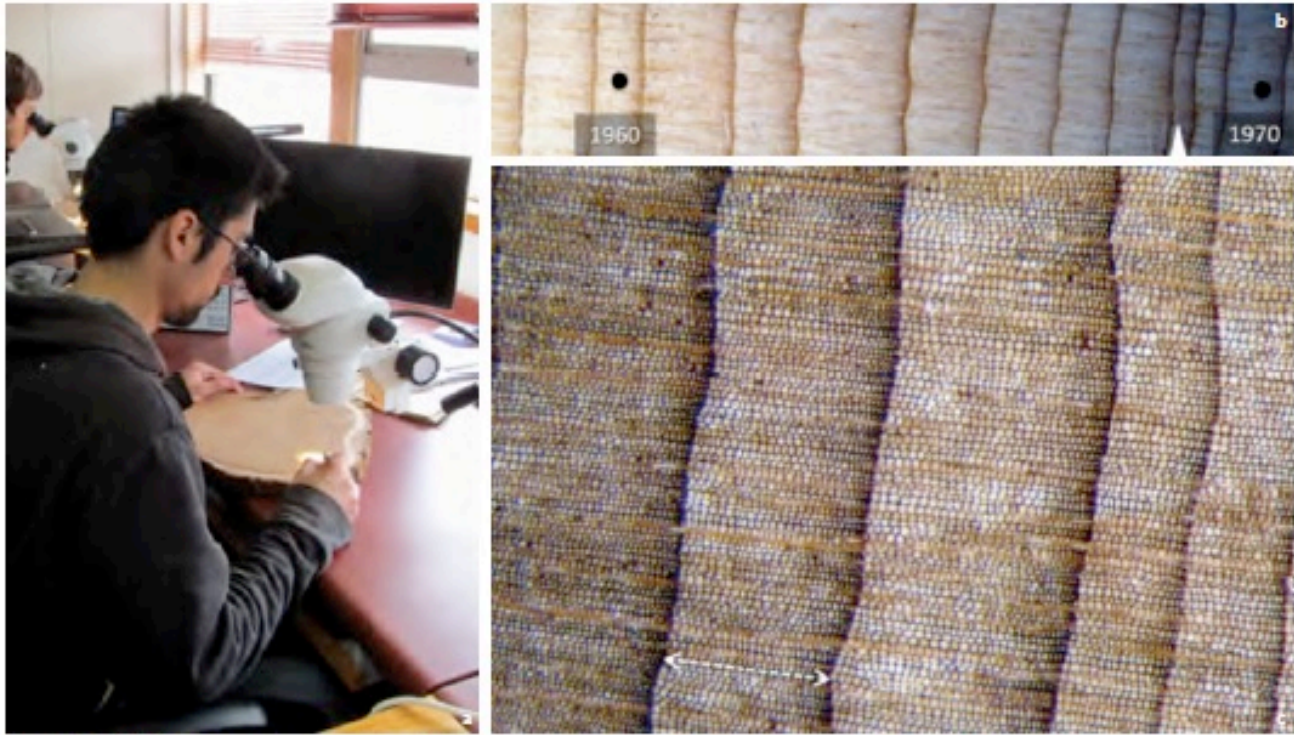
Figura 4. Análisis de muestras de madera procesadas (montadas y pulidas) en laboratorio. a: Este procedimiento precisa una lupa estereoscópica con aumento de 50x. b: Secuencia de anchos de anillos de crecimiento anuales donde se observa la sensibilidad del crecimiento de A. chilensis a la disponibilidad de agua. Destaca el anillo estrecho formado durante el año 1968 (flecha), que corresponde a una intensa sequía en la zona (10x). c: Visión transversal de la madera de A. chilensis . El tejido está conformado por células (traqueidas) con espesor de paredes y diámetro de lúmenes variables en la conformación del anillo de crecimiento. Las líneas oscuras verticales delimitan los anillos de crecimiento anuales (flecha segmentada), y las bandas horizontales más claras corresponden a los radios medulares (30x).
