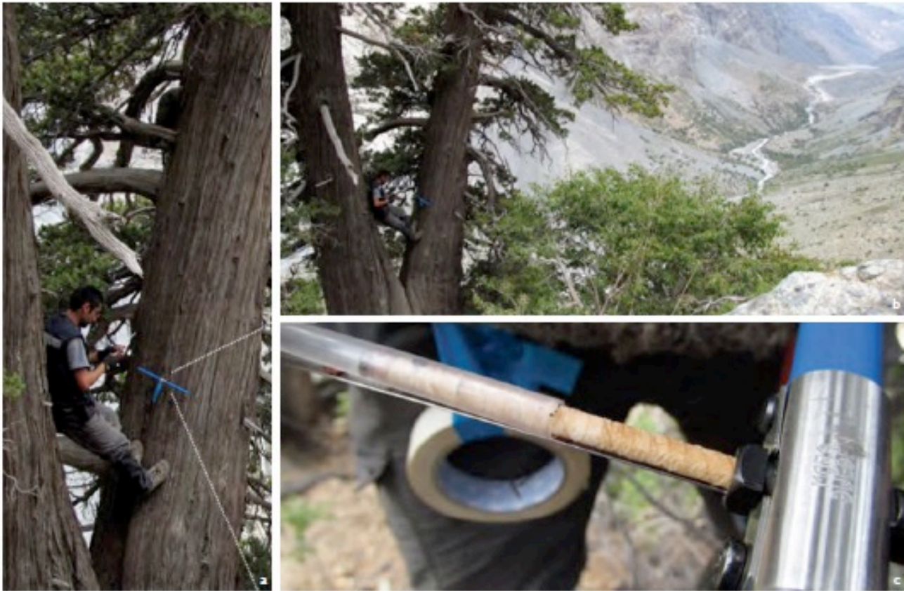
Figura 3. Muestreo de árboles vivos de A. chilensis : a: Obtención de muestra perpendicular al fuste con taladro de incremento. b: Cuenca del río Cachapoal, donde crecen árboles longevos de ciprés sobre rocas, al fondo río Cortaderal. c: Detalle de testigo radial de la madera (0,5 cm de diámetro), que contiene los anillos de crecimiento anual. Para extraerlo se utiliza un taladro de incremento.
